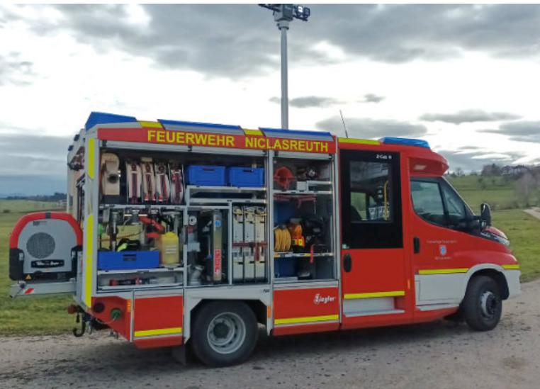
erschein bzw. der „alten Klasse 3“ gefahren werden. Der Aufbau kann durch das Schienen- und Profilsystem individuell an die Bedürfnisse angepasst werden. Die Z-Cab Kabine bietet sehr viel Platz und ist mit zwei Atemschutzgeräte in Fahrtrichtung ausgestattet. Die zwei zusätzlichen Atemschutzgeräte sind im Aufbau verbaut.
