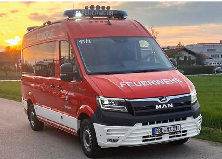
Die Herausforderung bei der Planung des Fahrzeugs bestand darin, dass das zulässige Gesamtgewicht die 3,49 t nicht übersteigt. Denn nur so war sichergestellt, dass alle Kameradinnen und Kameraden mit Führerschein das Fahrzeug fahren dürfen und keine extra Fahrerausbildung notwendig wird.
